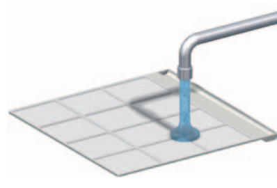
Fig. 10 Limpieza con agua tibia
