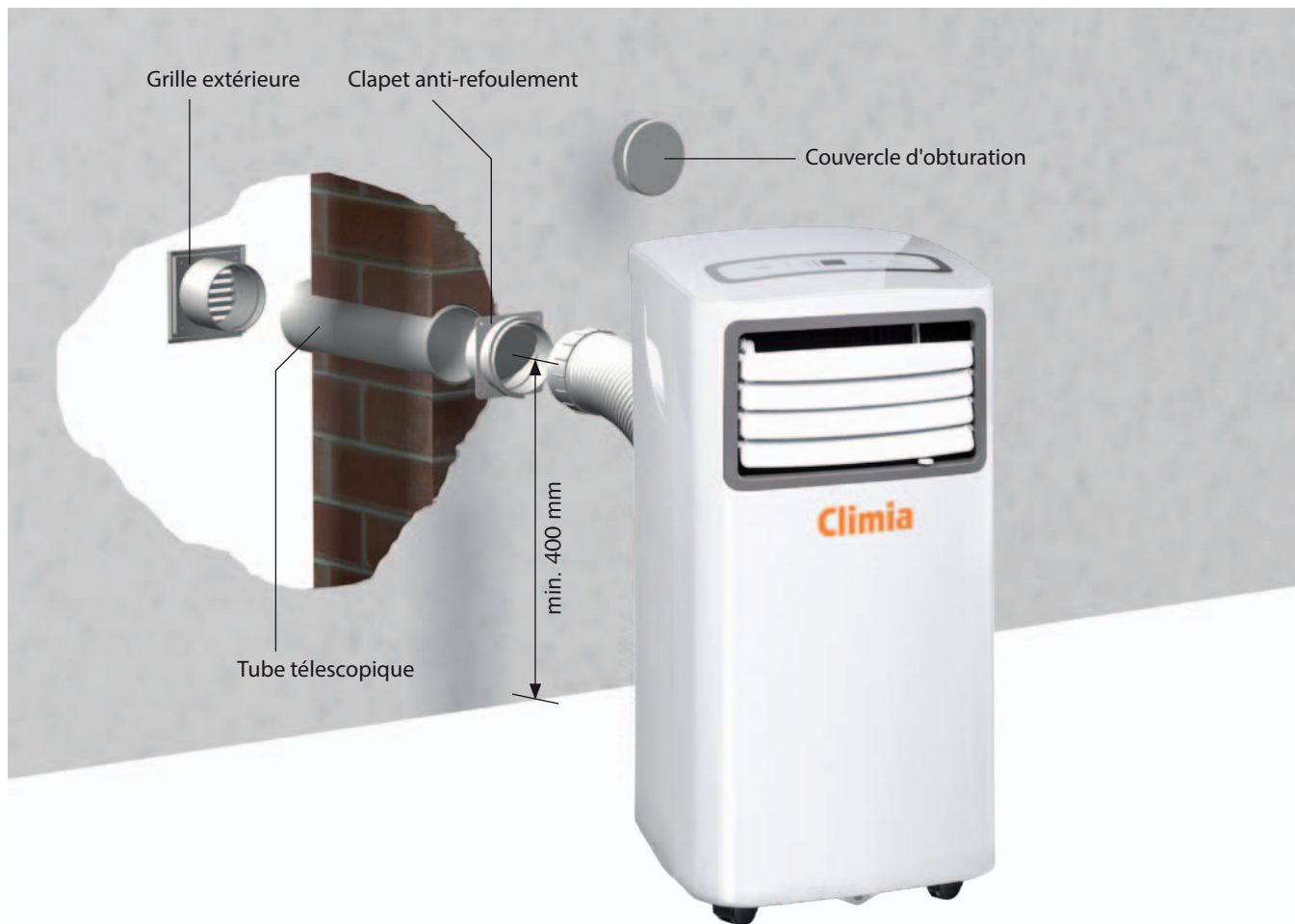
Fig. 11 Exemple de montage
