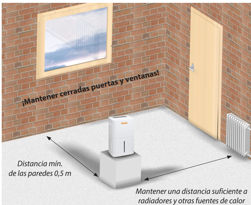
Fig. 2 Representación esquemática de la instalación del deshumidificador
