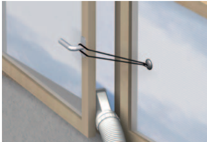
Abb. 4 Abluft bei geöffnetem Fenster
